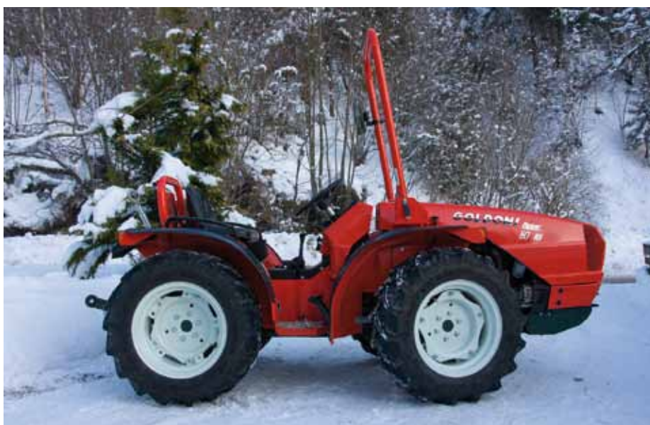
Goldonijevo oglat, a očem prijetne oblike. Blatniki so iz močne pločevine, varnostni lok je preklopne izvedbe.
