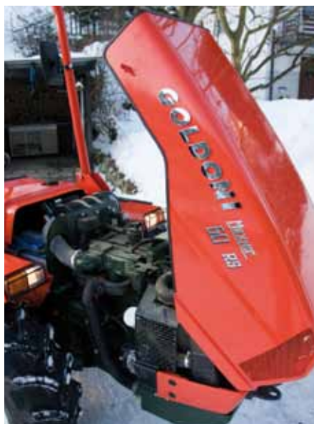
Motorni pokrov se odpira naprej. Izpuh je speljan v lonec pod traktorjem z izpušno odprtino na levi strani. Zračno filter je lahko dostopen, ravno tako akumulator.
