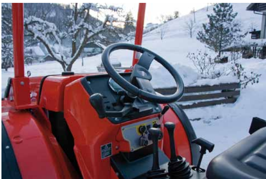
Ročice menjalnika, skrajno desno ročna zavora, levo zgoraj ročica za izbiro smeri vožnje, desno zgoraj ročica ročnega plina. Rezervoar goriva je popolnoma ločen od motornega dela.
