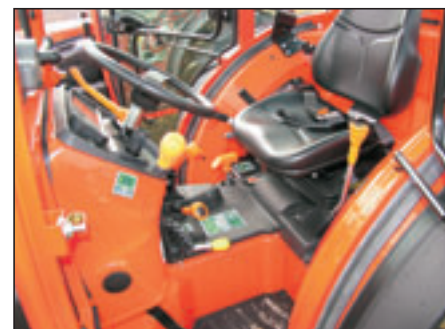
Menjalnik s 40 sinhroniziranimi prestavami. S preprostim preklopom ročice lahko izberete za delo invertorski menjalnik s prestavnim razmerjem 8 prestav za vožnjo naprej in 8 prestav za vzvratno vožnjo ali pa izberete reducirani menjalnik (polovičke) s 16 prestavami za vožnjo naprej in 8 prestavami za vzvratno vožnjo (Dual power).
