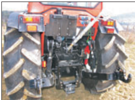
Hidravlično dvigalo I. in II. kategorije, zadaj so trije hidravlični izhodi za zunanje uporabnike in rezervoar za gorivo.
